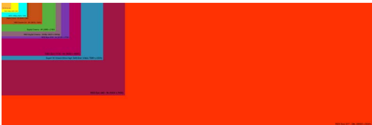
Fig.15: Detalle de la norma de Cine Digital RED EPIC 617 – 28K (28000x9334 pixeles) en rojo. RED EPIC 645 quedó en carmín, mientras que también aquí Full HD para TV Digital está en celeste en el margen superior izquierdo.
